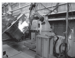
タービンベッドを機械加工する様子
